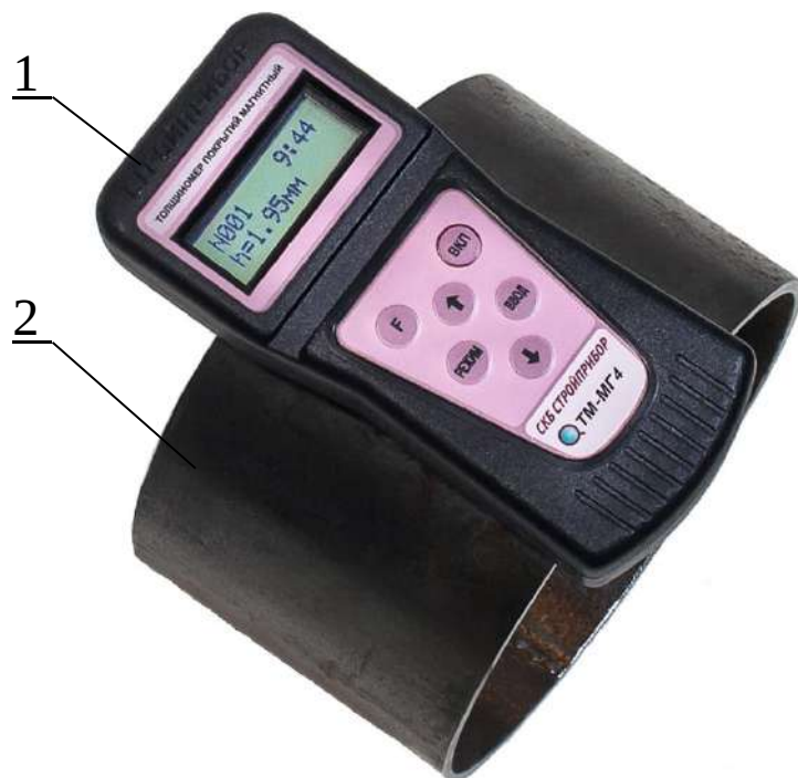
Рисунок 2.1 – Положение толщиномера на изделии при измерении
